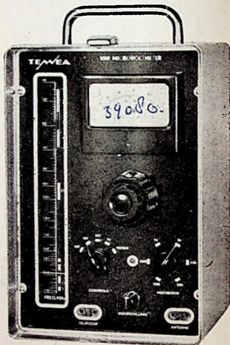
DE VHF MICROVOLTMETER met afgenomen beschermdeksel
