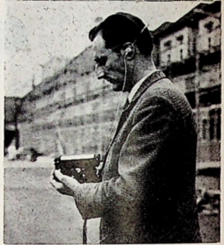
Naast het bepalen van de standplaats van een zender kan het toestel ook als gewone ontvanger dienst doen.
